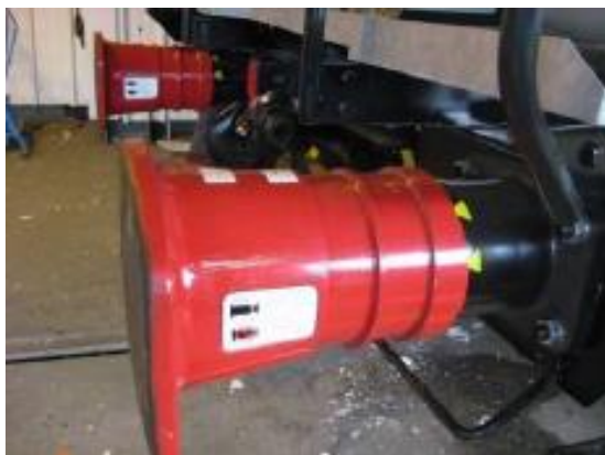
Figura 6.11. Exemplu de tamponare speciale
