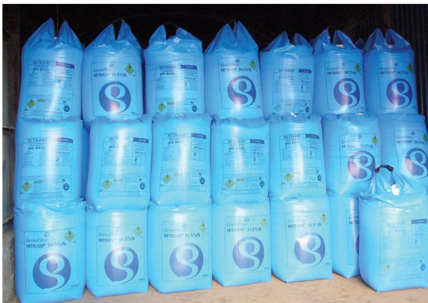
Figura 6.12. Exemple de big bags de 1000 kg fiecare pentru transportul azotatului de amoniu
