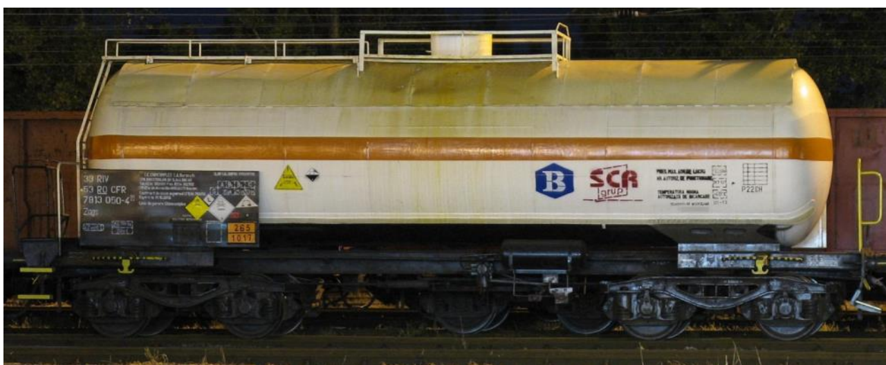
Figura 6.5. Exemplu de cisternă de transport feroviar clor
